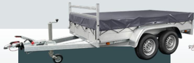
Couvrez votre chargement avec une bâche plate , faite d'une toile robuste. Montage facile avec des crochets mobiles.
