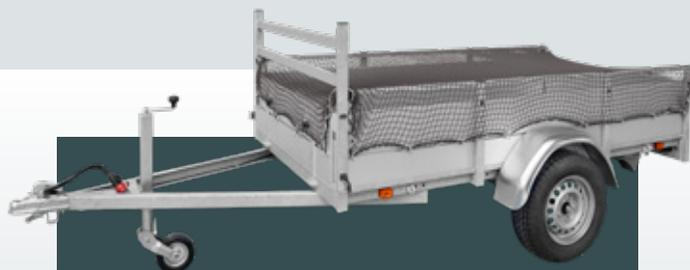
Montage facilement d'un filet de remorque avec des crochets que vous pouvez monter sur chaque position dans la rainure.
